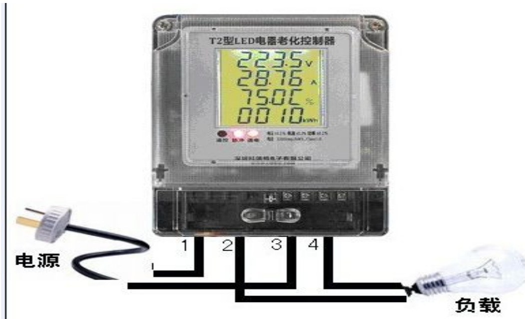
6、T2 电器老化控制器老化接线示意图
