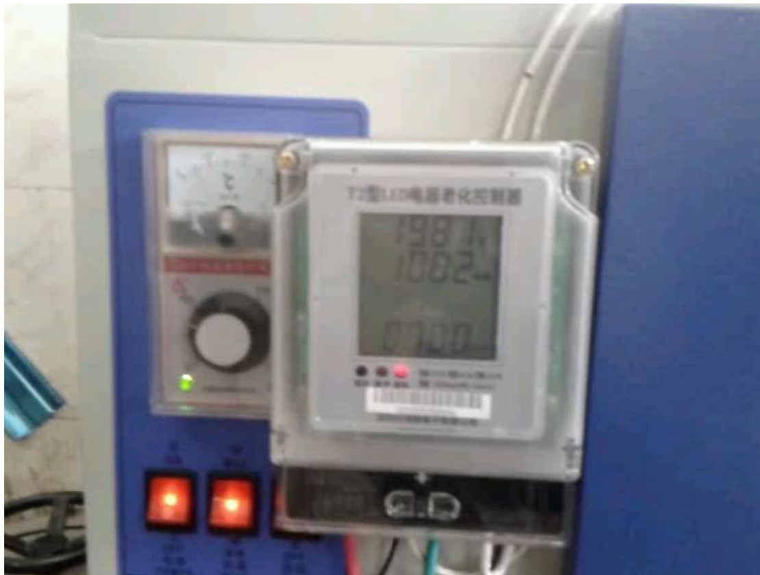
T2 电器老化控制器用在烤箱上做形式实验
